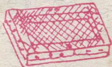
e) El bastidor superior lleva dos clavos pasados, ajustados en los hoyitos de inferior. Este bastidor superior servirá de "margen" del papel reciclado.
