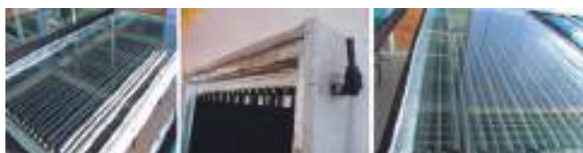
Imágenes de colectores solares de autoconstrucción para pruebas de eficiencia. Archivo MArch Carolina Sepúlveda, 2012, Valdivia.
