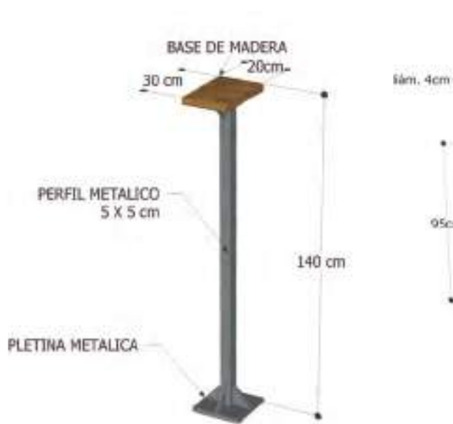
APOYA CÁMARA (MIRADORES DE CAMINO)
